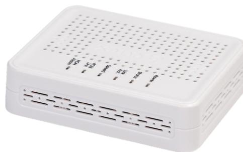
**ONT NTU-1** — абонентские терминалы, предназначенные для подключения пользователей к сети передачи данных по технологии GPON.
