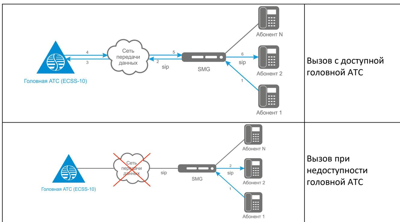
Потребуется создать на SMG транковый SIP-интерфейс в сторону головной АТС и настроить интерфейс для регистрации абонентов таким образом, чтобы он использовал sip-транк в сторону ECSS-10 в качестве интерфейса urreg-регистрации.
