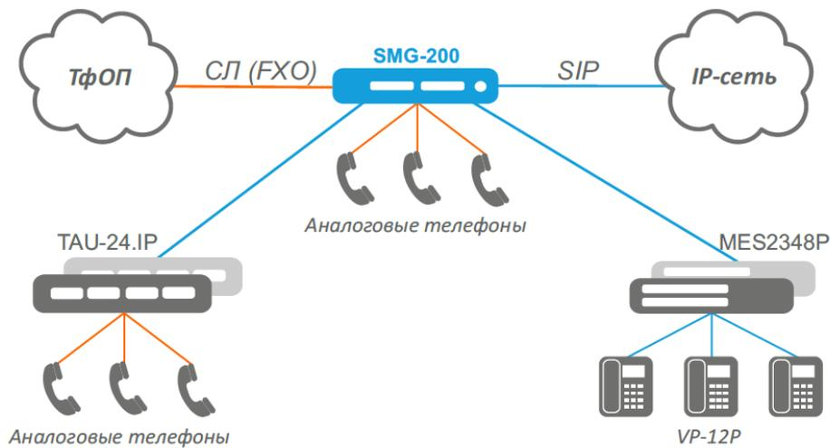
Рисунок 1 — Офисная IP-АТС на базе SMG-200
