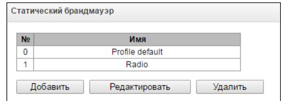
Программное обеспечение позволяет настроить правила firewall для входящего, исходящего и транзитного трафика, а также для определенных сетевых интерфейсов.
