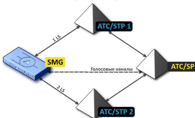
Рисунок 19 — Схема подключения SMG в комбинированном режиме
