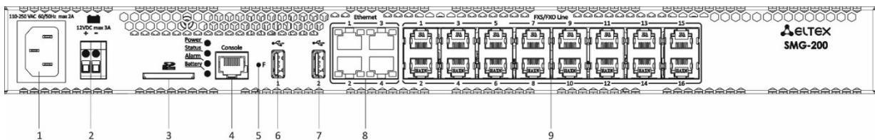
Рисунок 6 — Внешний вид передней панели SMG-200
