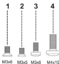
Рисунок 12 — Типы винтов для сборки SMG
