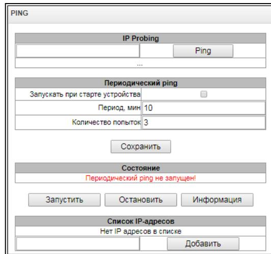
**IP Probing** — используется для однократного контроля соединения до устройства в сети.
