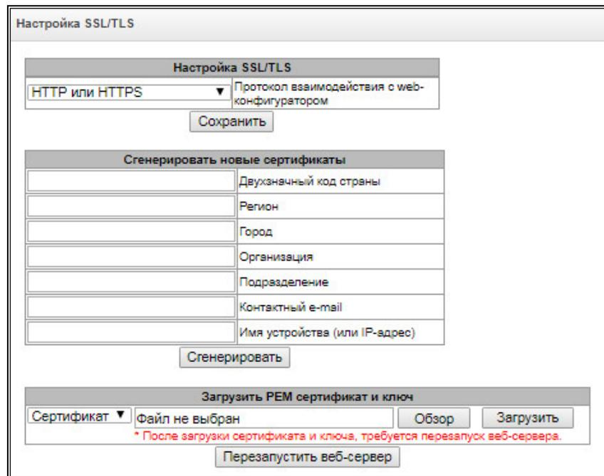
Данный раздел предназначен для получения самоподписанного сертификата, который позволяет использовать шифрованное подключение к шлюзу по протоколу HTTP и загрузку/выгрузку файлов конфигурации по протоколу FTPS.
