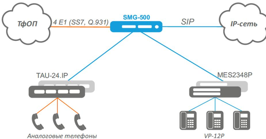
Рисунок 2 — Офисная IP-АТС на базе SMG-500
