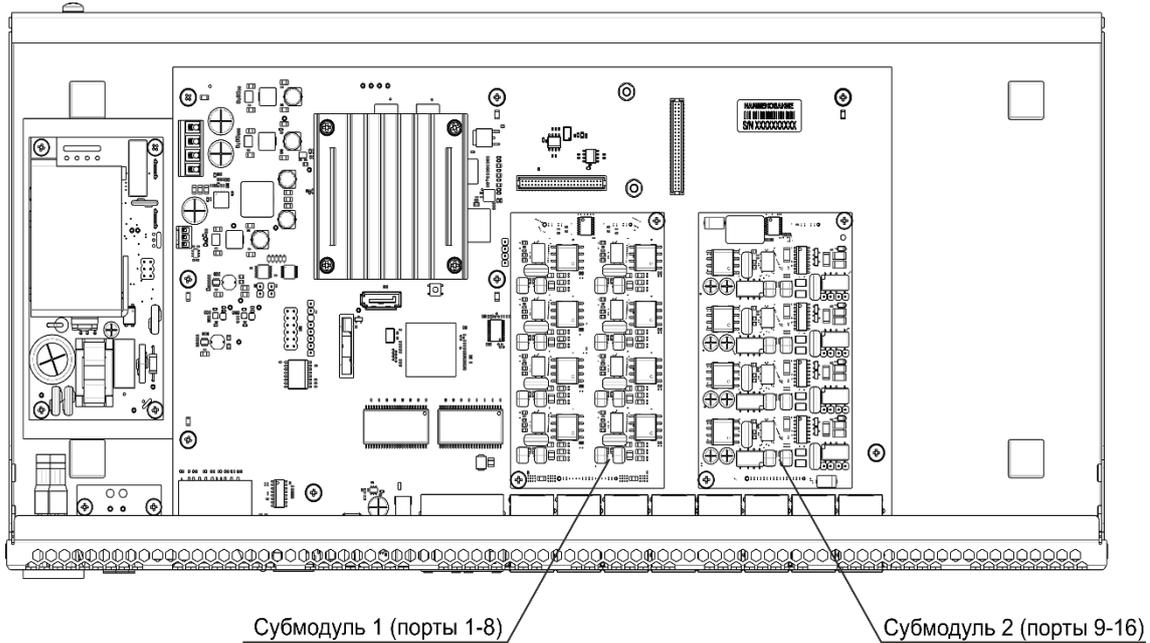
Рисунок 13 — Расположение submodule в SMG-200
