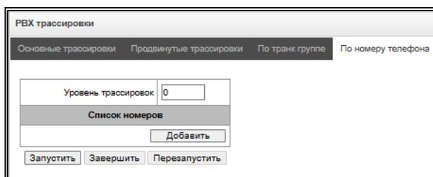
В этом разделе запускается снятие логов PBX\_PSTN по выбранному номеру телефона. Отбор идет одновременно как по номерам CdPN, так и CgPN. Уровни трассировок работают аналогично настройкам уровней трассировок PBX\_PSTN из вкладки «Общие настройки» за тем исключением, что для всех протоколов будет выставлен единый уровень логирования.
