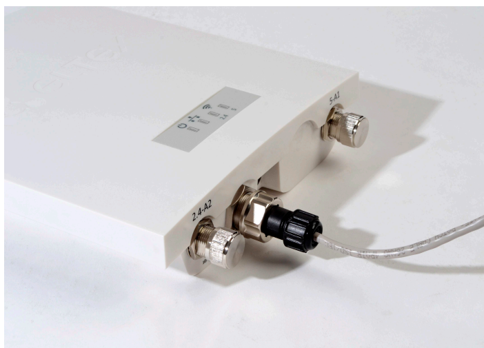
Рисунок 23 – Вид подключенного кабеля к сетевому интерфейсу устройства
