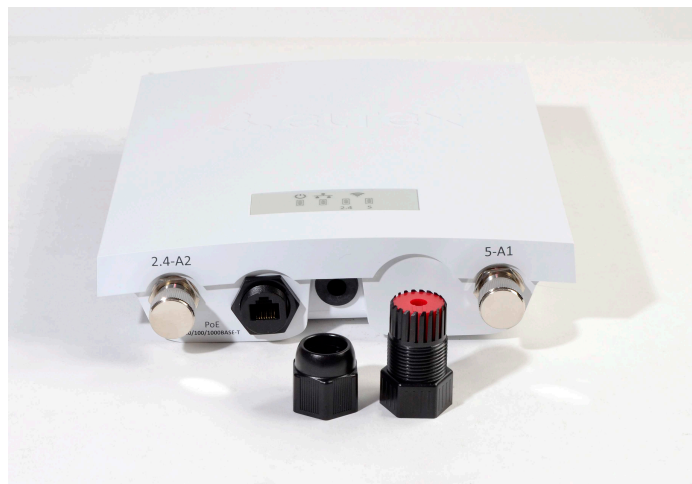
Рисунок 15 – Герметичный разъем RJ-45 на устройстве и ответная часть в разобранном виде для аппаратных версий 1v3 и выше
