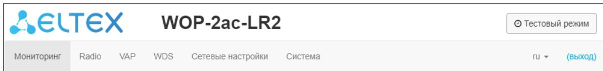
Время работы тестового режима – 300 секунд (5 минут). В течение этого времени можно перемещаться по вкладкам web-конфигуратора и производить какие-либо изменения, применяя их на каждой странице с помощью кнопки «Применить».
