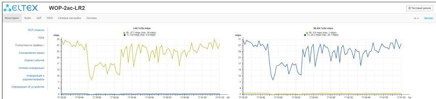
График LAN Tx/Rx показывает скорость приема/передачи трафика через Ethernet-интерфейс точки доступа за последние 3 минуты. График автоматически обновляется каждые 2 секунды.
