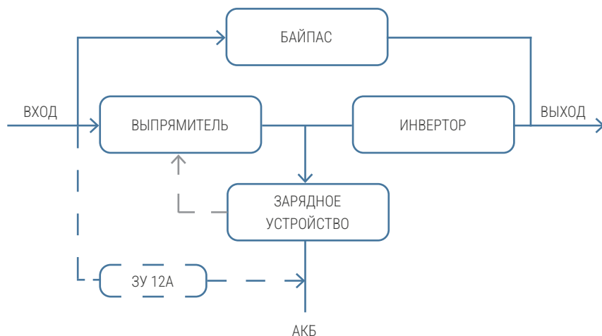
Рисунок 1-4 – Структурная схема ИБП
