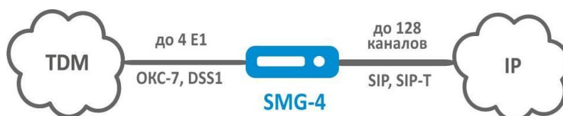
Рисунок 1 – Сопряжение сигнализаций и медиапотоків TDM- и VoIP-сетей с использованием SMG-4
