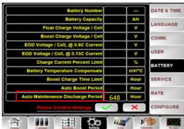
Рис 4-4. Настройка интервала тестирования АКБ.
