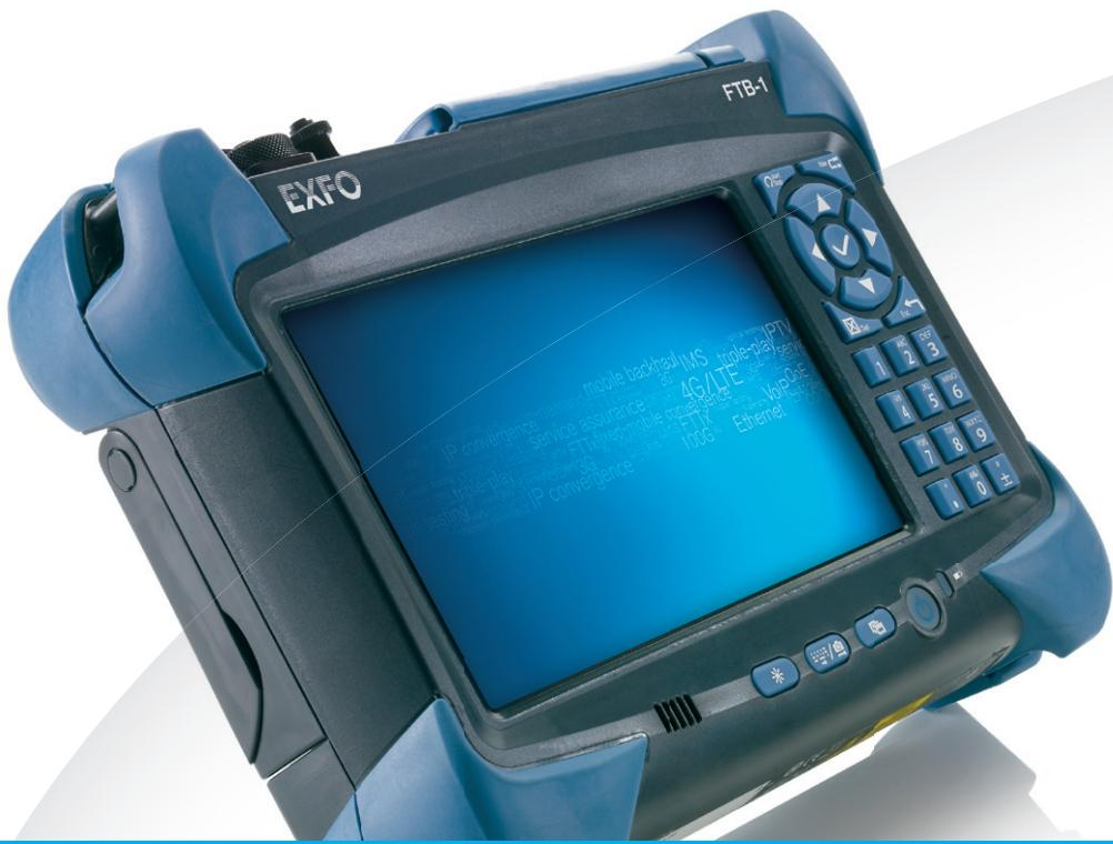
FTB-1 представляет собой модульную платформу, предназначенную для быстрого и тщательного исследования сетей FTTN и Ethernet
