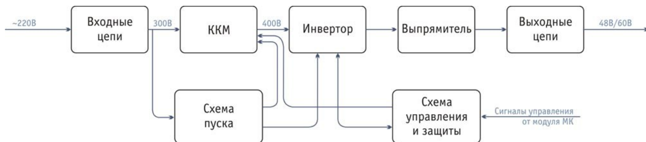
Рисунок 2 – Структурная схема модуля МП800
