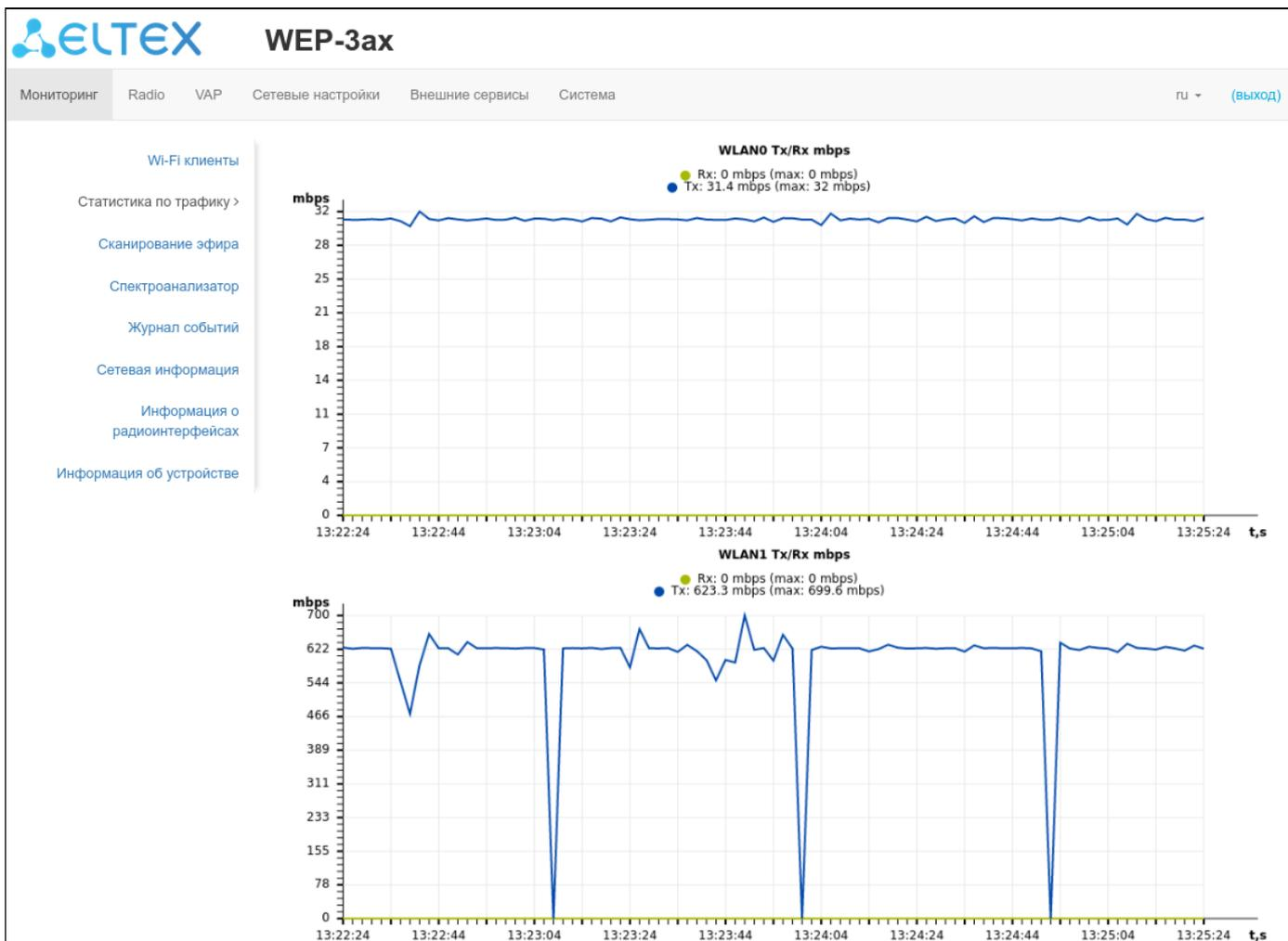
Графики WLAN0 и WLAN1 Tx/Rx показывают скорость переданного/полученного трафика через Radio 2.4 ГГц (WLAN0) и Radio 5 ГГц (WLAN1) интерфейсы точки доступа за последние 3 минуты. График автоматически обновляется каждые 2 секунды.
