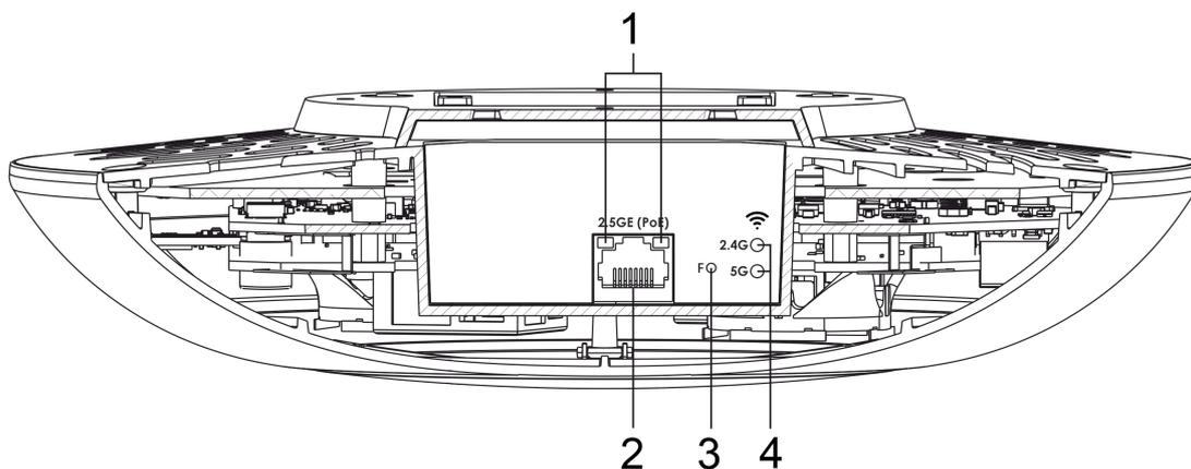
Рисунок 2 – Внешний вид основной панели WEP-3ax, WEP-3ax-Z
