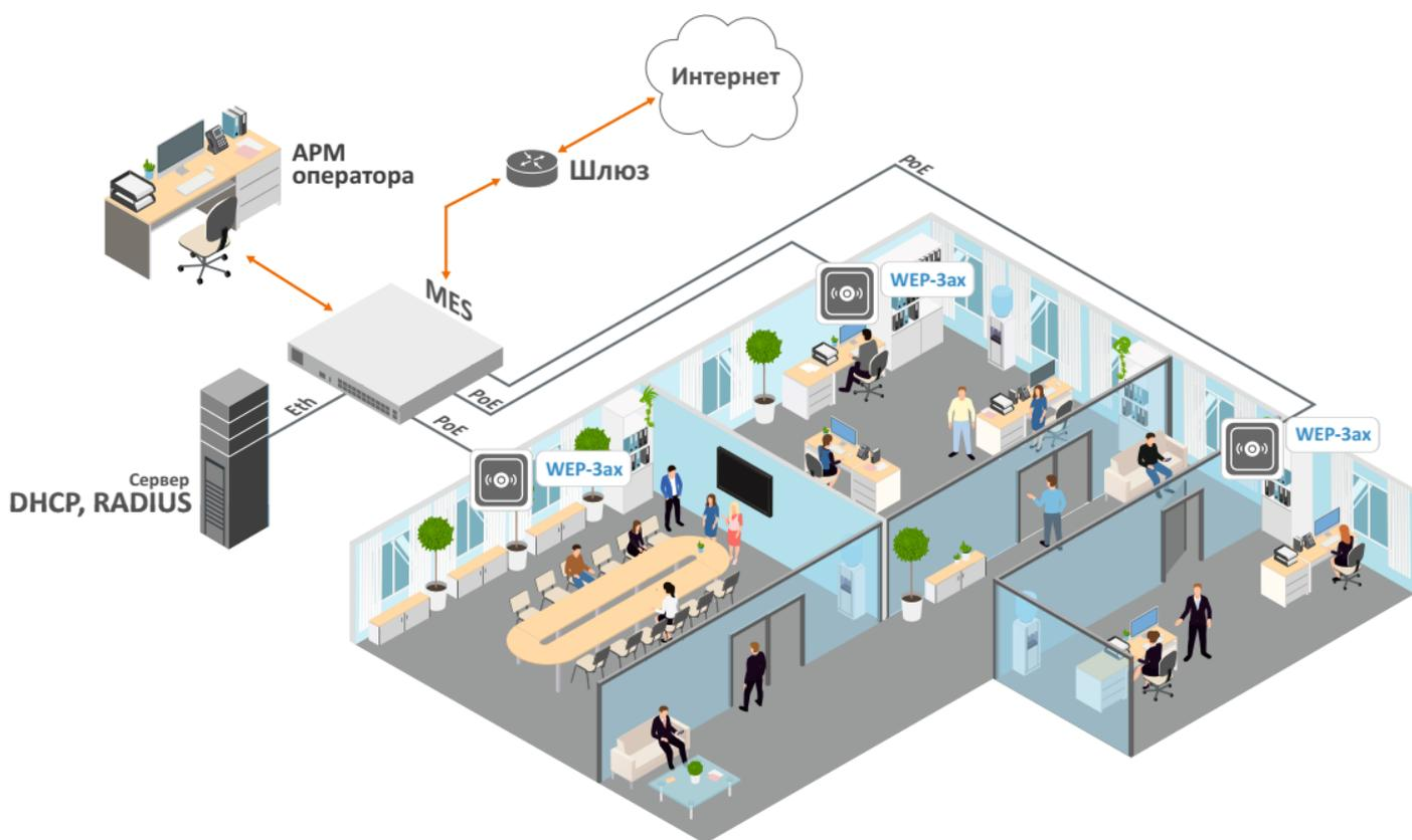
Рисунок 1 – Функциональная схема использования WEP-3ax, WEP-3ax-Z
