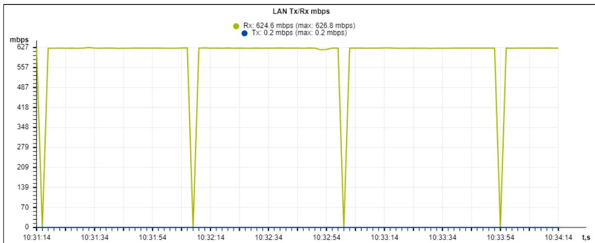
График LAN Tx/Rx показывает скорость переданного/полученного трафика через Ethernet-интерфейс точки доступа за последние 3 минуты. График автоматически обновляется каждые 2 секунды.
