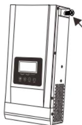
Закрепите на стене на 2 винта (рисунок справа)
