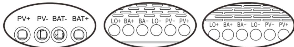
В первую очередь рекомендуется подключать батарейные провода, потом провода солнечных панелей и лишь потом провода нагрузки (выход нагрузки есть только на модели UB100).
