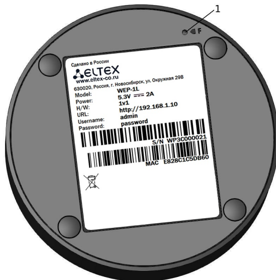
Рисунок 4 - Внешний вид нижней панели WEP-1L
