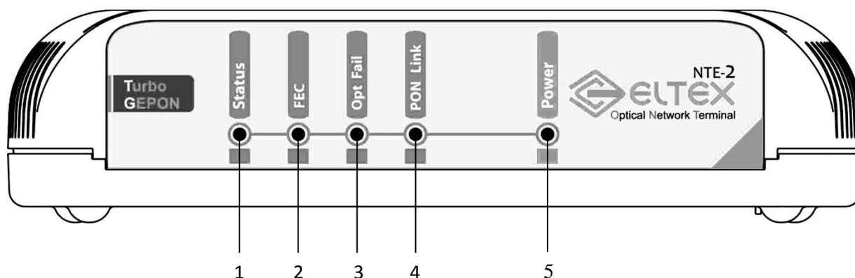
Рисунок 2 – Передняя панель абонентского терминала NTE-2, NTE-2c
