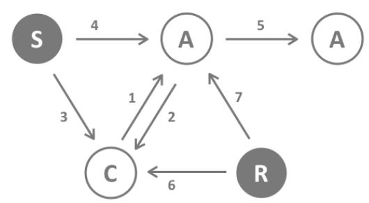
Контроллер может быть первичным и вторичным. Первичным может быть только один контроллер в сети, он управляет сетью и обеспечивает включение/исключение устройств.
