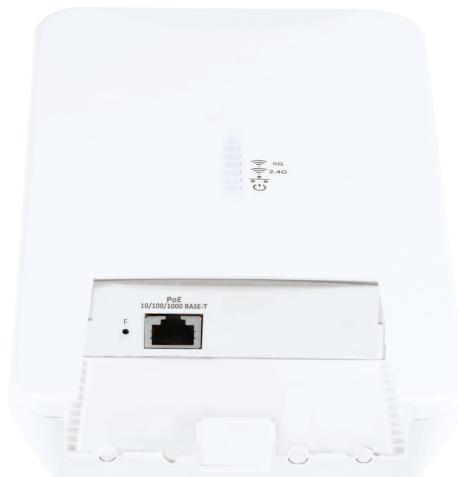
Рисунок 3 – Внешний вид нижней панели WOP-20L
