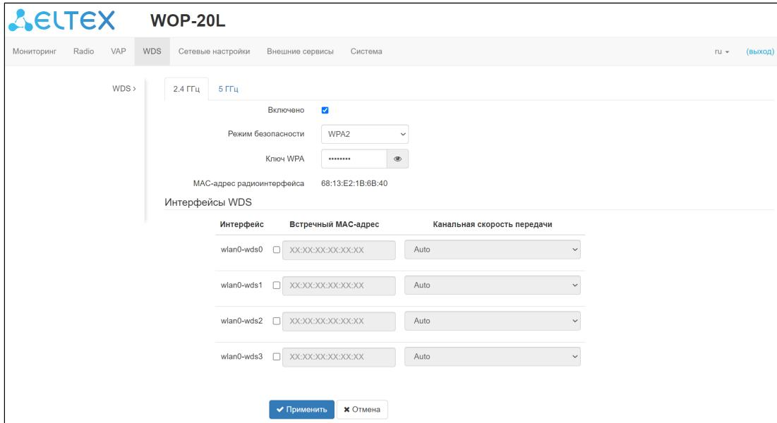
Во вкладках «2.4 ГГц» и «5 ГГц» выбирается радиоинтерфейс устройства, на котором необходимо построить беспроводной мост.
