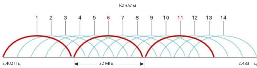
Рисунок 4 – Общая диаграмма перекрытия частотных каналов в 2.4 ГГц
