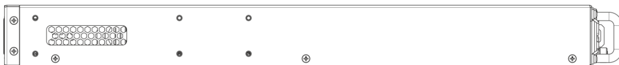
Рисунок 8 – Левая боковая панель MES7048
