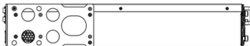
Рисунок 8 – Левая боковая панель ESR-1700
