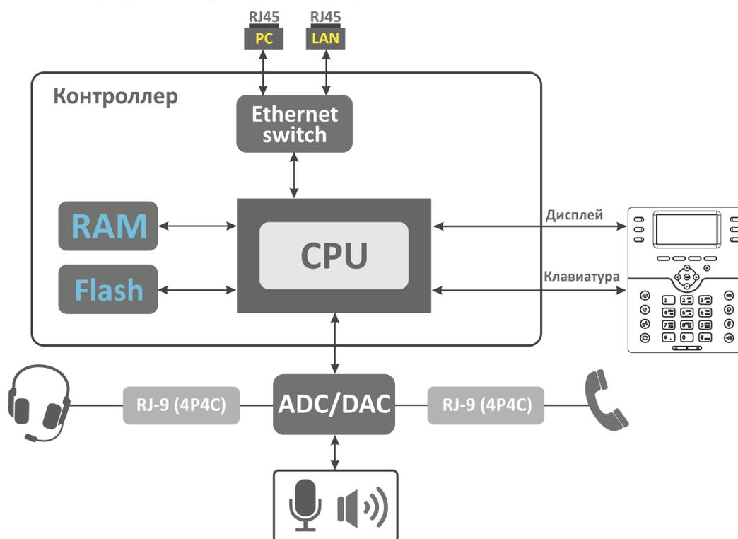
Устройство работает под управлением операционной системы Linux. Основные функции управления сосредоточены в процессоре Realtek, который осуществляет маршрутизацию IP-пакетов, обеспечивает работу IP-телефонии.
