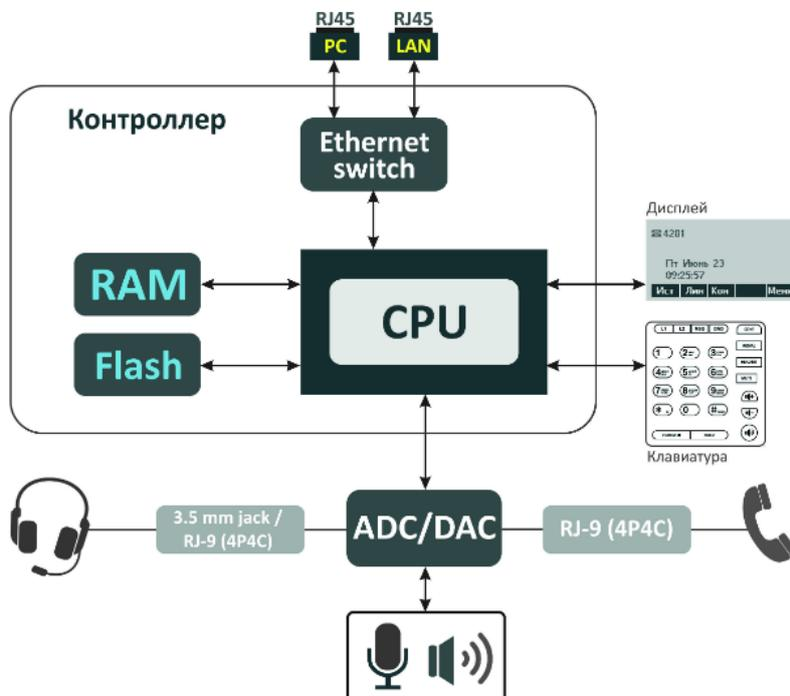
Устройство работает под управлением операционной системы Linux. Основные функции управления сосредоточены в процессоре Realtek, который осуществляет маршрутизацию IP-пакетов, обеспечивает работу IP-телефонии.
