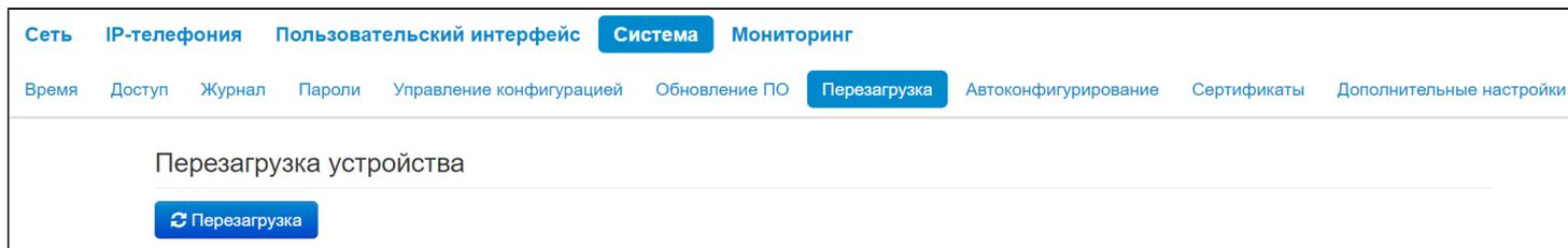
Для перезагрузки устройства нажмите на кнопку «Перезагрузить». Процесс перезагрузки устройства занимает примерно 1 минуту.
