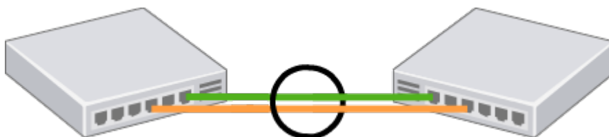
Рисунок 27 – Объединение нескольких физических каналов в группу агрегации
