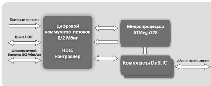
Рисунок 6 – Функциональная схема модуля 24АК (24АК-Д)
